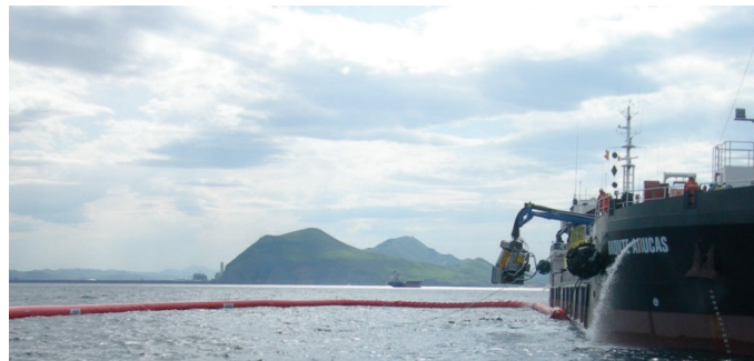
Déploiement du skimmer et du barrage flottant. Exercice anti-pollution réalisé avec le concours du Monte Arucas
