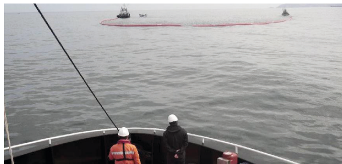
Déploiement du barrage dans une configuration en forme de U. Exercice anti-pollution réalisé avec le concours du Monte Arucas.
