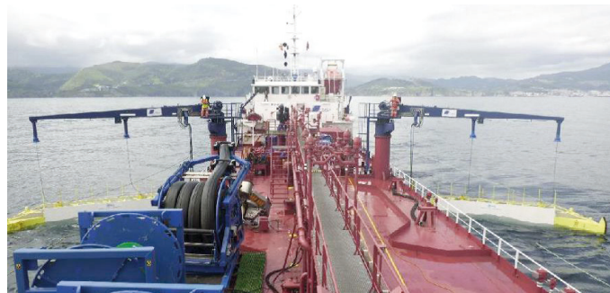
Déploiement des bras articulés. Exercice anti-pollution réalisé avec le concours du Monte Arucas.
